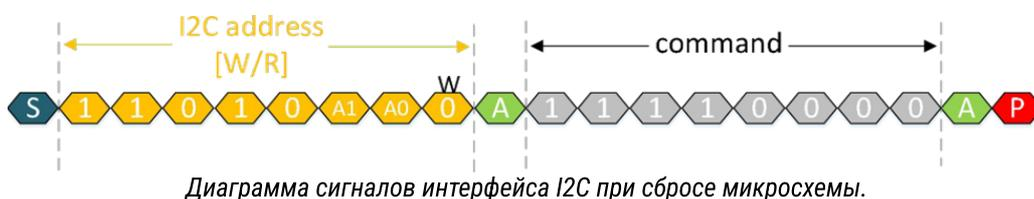
Если микросхема находится в режимах: непрерывного преобразования, режиме пониженного энергопотребления, то перед сбросом микросхемы необходимо подать команду перехода в режим "конфигурация" и только потом подавать команду сброса.
